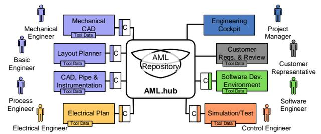
Das offene Datenaustauschformat **AutomationML** ermöglicht einen einfachen Zugriff auf ausgetauschte Engineering-Daten in Werkzeugnetzwerken.
