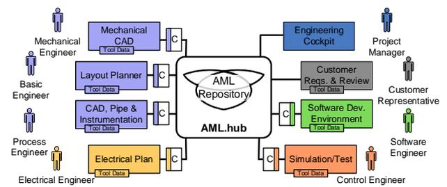
Das offene Datenaustauschformat *AutomationML* (AML) ermöglicht einen einfachen Zugriff auf ausgetauschte Engineering-Daten in Werkzeugnetzwerken mit dem AML.hub. Der AML.hub ermöglicht die schrittweise Migration zu einem AML-basierten Engineering Projekt.
